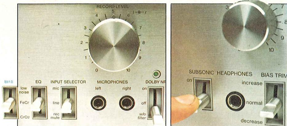
L'insieme delle commutazioni a pannello anteriore: da notare la presenza di un filtro subsonico e del « muting » per ottenere, nel corso della registrazione, delle spaziature tra le diverse parti che compongono il programma.
