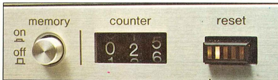
Sul pulsante di reset del contanastro è stato ricavato un originale indicatore luminoso di scorrimento del nastro.
